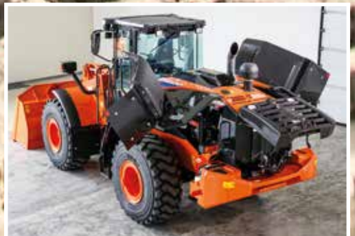
Nem adgang til vedligeholdelse fra terrænniveau.
