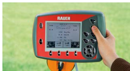
Rauch sprederne leverer en præcis og sikker dosering. Med styring via computer kan spredningen dokumenteres.
