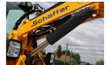
Løftecylinderen er specielt dimensioneret til de store løft og monteret med kugleled som beskyttelse mod vrid og slid.
