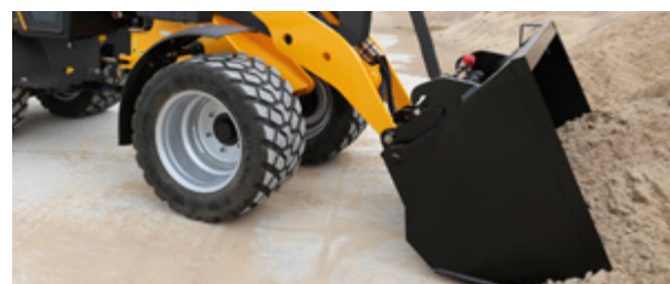
Den høje skubbekraft øger produktiviteten. Læsehøjden på 2.60m er tilpas for af- og pålæsning af lastbiler uden problemer.
