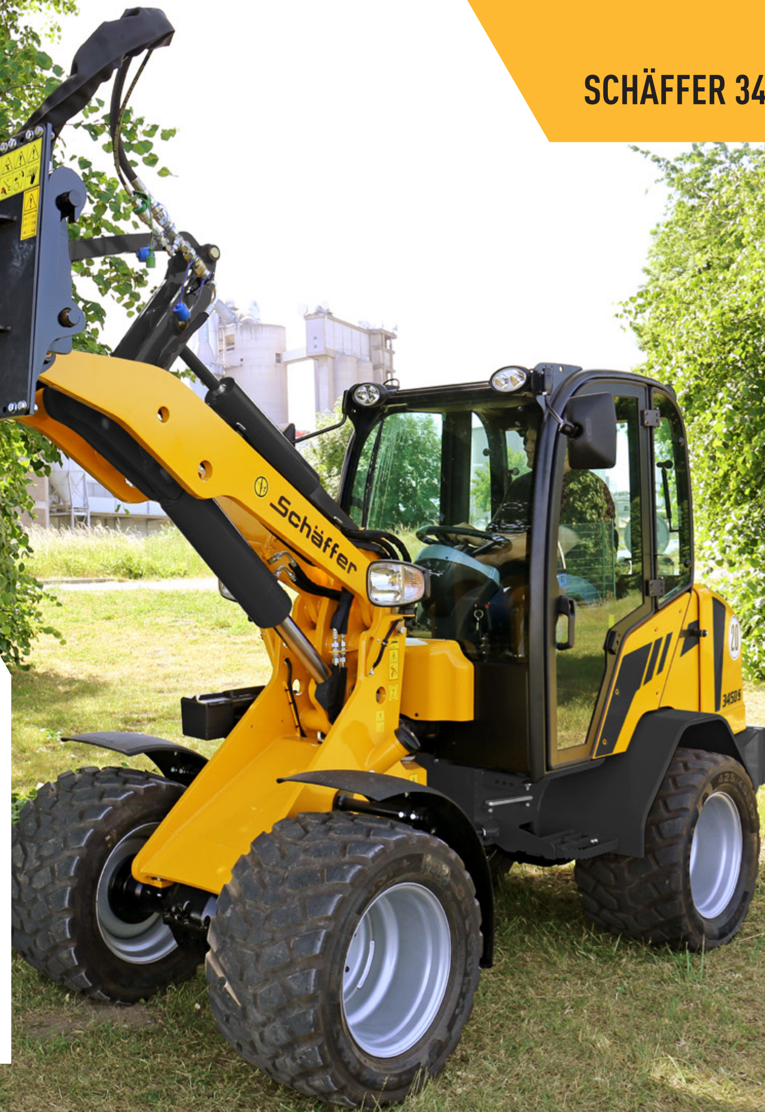
Schaffer 3450S løfter og håndterer paller på 2.0 ton. Den smalle og lave forende og tårn giver føreren optimalt udsyn til redskaber og last.
