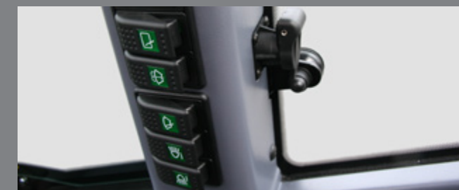
Samlet betjeningspanel og 12V udtag
