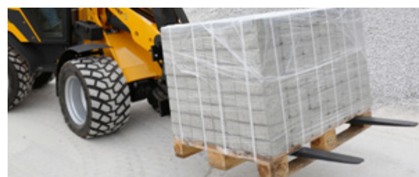
Schaffer 3450S løfter og håndterer paller på 2.0 ton. Den smalle og lave forende og tårn giver føreren optimalt udsyn til redskaber og last.
