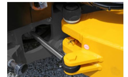
Det hydrauliske knæklæd med pendling er vedligeholdelsesfrit og med udvidet garanti.
