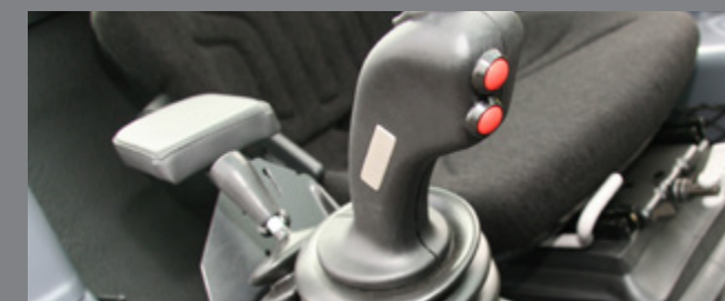
Ergonomisk multifunktions joystick
