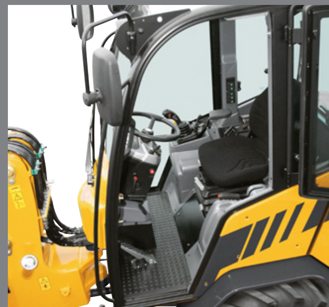
Samlet betjeningspanel og 12V udtag
