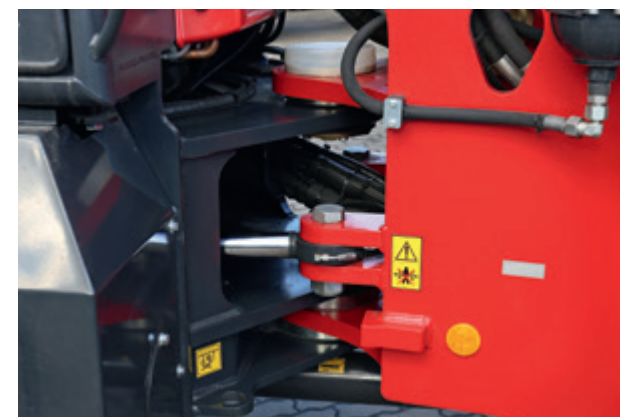
Knæleddet er ekstremt stærkt og og vedligeholdelsesfrit. De to styrecylindrer giver perfekt control.
