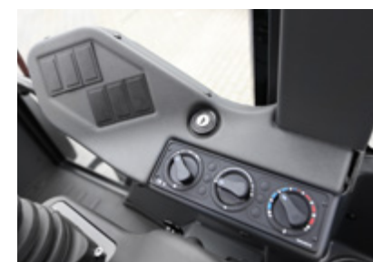
Nyt konsol: Tændingslås, kontrolpanel til varme og evt. airconditioning eller Klima anlæg er nemme at nå.
