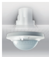
Nem indbygning i loft med standard-borekrone (Ø 68 mm)
