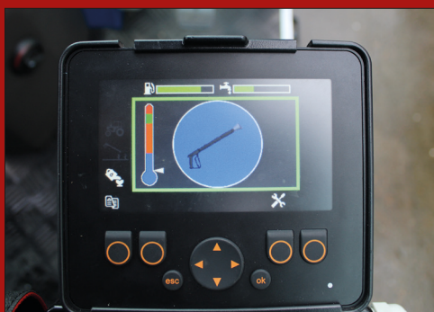
Med den elektroniske styring sikres fuldt overblik direkte fra kabinen og giver let betjening af alle systemets funktioner
