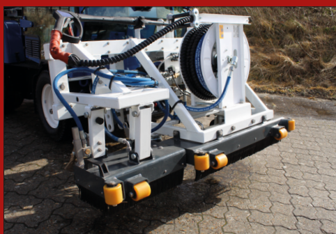
Hotwater fronten er sektionsopdelt hvilket gør det muligt at bekæmpe både på- og helt ind til fx kantsten
