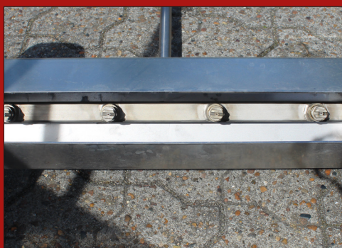
Spredébommen er monteret med fire dysser, som sikrer en ensartet bekæmpelse i hele spredereens arbejdsbrede
