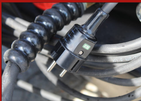
Hele systemet kan forsynes fra en ubelastet 230V stikkontakt og tilsluttes almindelig vandforsyning (Dog min. 8 liter/minuttet)
