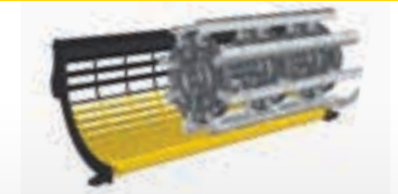
UNIVERSALCYLINDER, STANDARDSLAGLER OG TÆRSKEBRO TIL RIS
