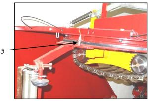
Sensor 6 Bale pos. max. error switch.
