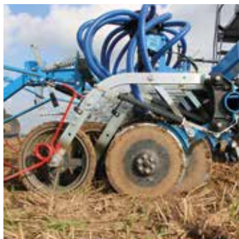
OptiDisc med dobbeltskiveskær mekanisk op til 45 kg skærtryk
