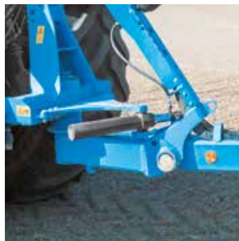
Diamant 16 plovstårn med OptiLine justeringssystem
