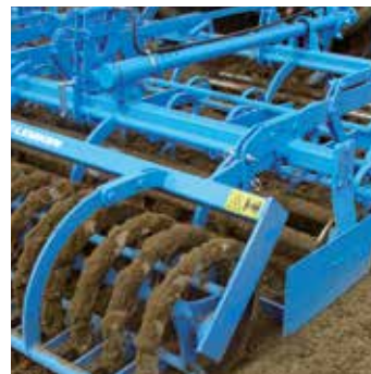
Hydraulisk indstilling af planeringsplanke
