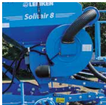
Hydraulisk drevet blæser
