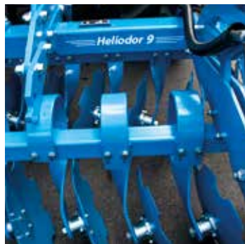
Tallerkenerne i området ved traktorsporet kan indstilles separat
