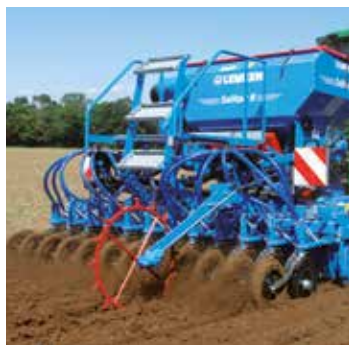
Trækjulet løber indenfor maskinens arbejdsbredde
