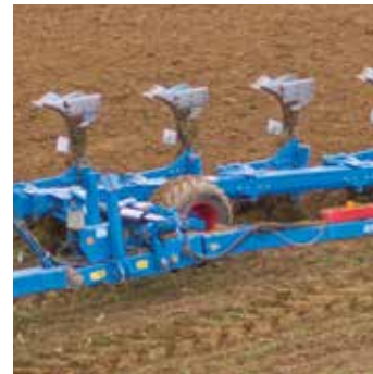
Det forreste landhjul anbragt inden for plovrammen
