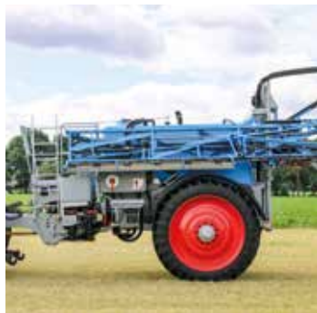
Kort akselafstand sikre god sporfølgning
