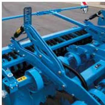
Hydraulisk indstilling af arbejdsdybden
