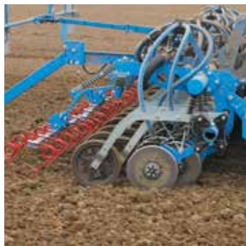
OptiDisc med dobbeltskiveskær hydraulisk op til 70 kg skærtryk
