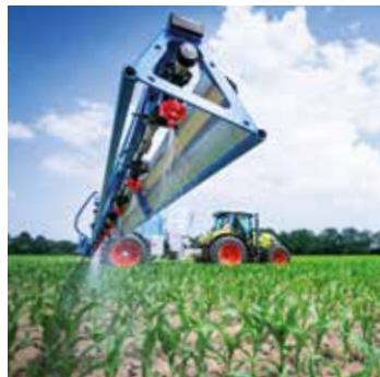
Beskyttet dyse placering, også ved lange dyser
