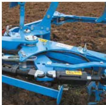
Cylinder til indstilling af arbejdsbredde
