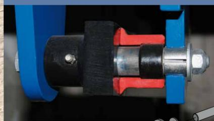
Ved alle dreje- og befæstelses steder bliver der monteret det nye Lockpin system: En aksel erstatter de forhenværende bolte. På de konusformede ender på akslen bliver der monteret en konisk bøsning, som bliver spændt sammen med en bolt. Derved bliver Lockpinen fikseret.
