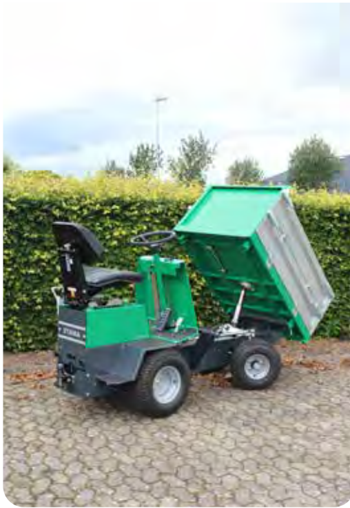
Hydraulisk 3-vejs tip
