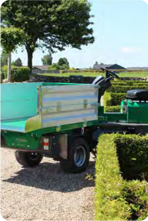
Knækstyring for passage på smalle stier
