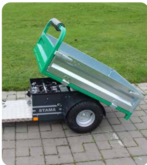
Tiplad for aflæsning og adgang til batterier
