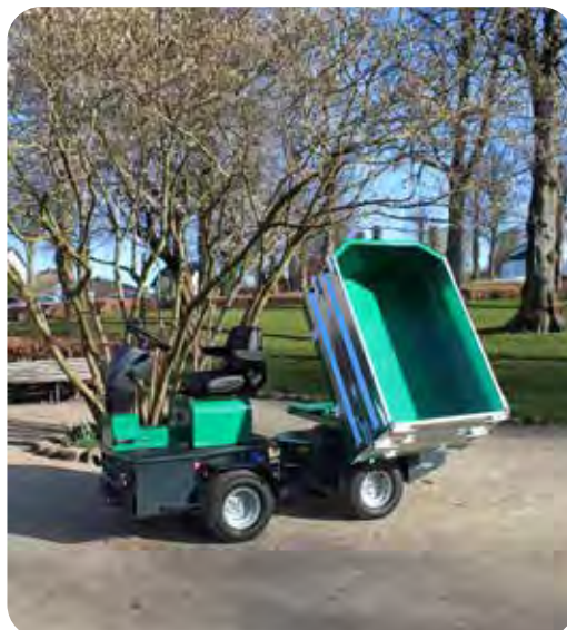
Hydraulisk tiplad med hydraulisk sving
