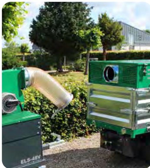
Hurtig tilkobling af udkast til køretøjets lad
