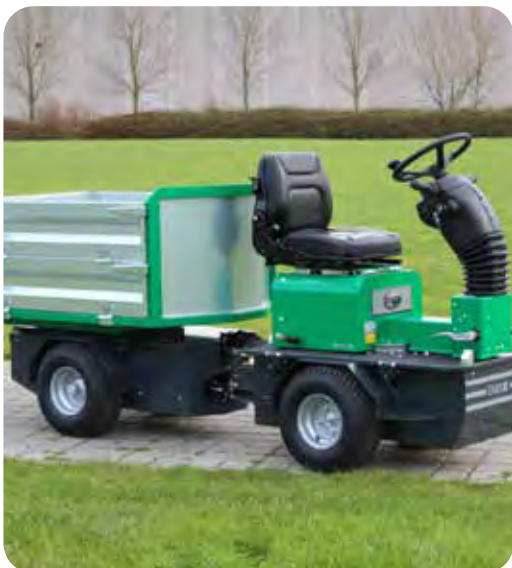
Vendbar førerplatform med lad foran eller bagved
