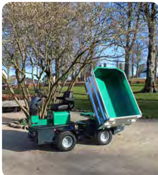
Hydraulisk tiplad med hydraulisk sving
