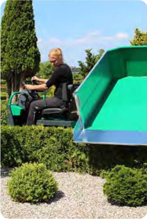
Hydraulisk tiplad med 180° sving
