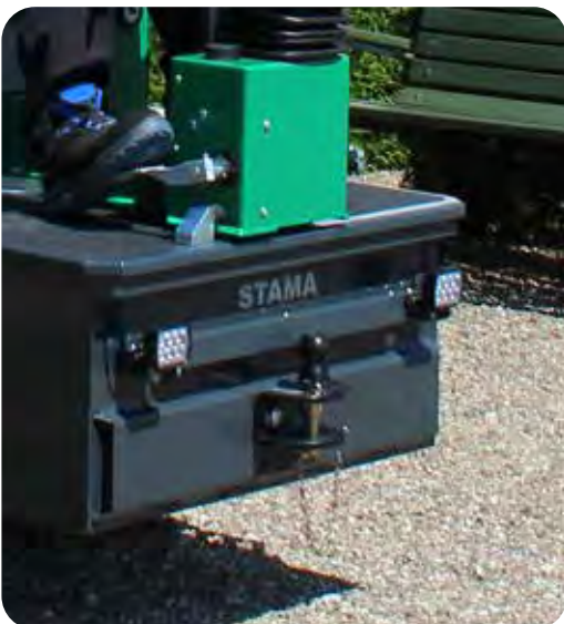
Kan monteres med træk og frontlift
