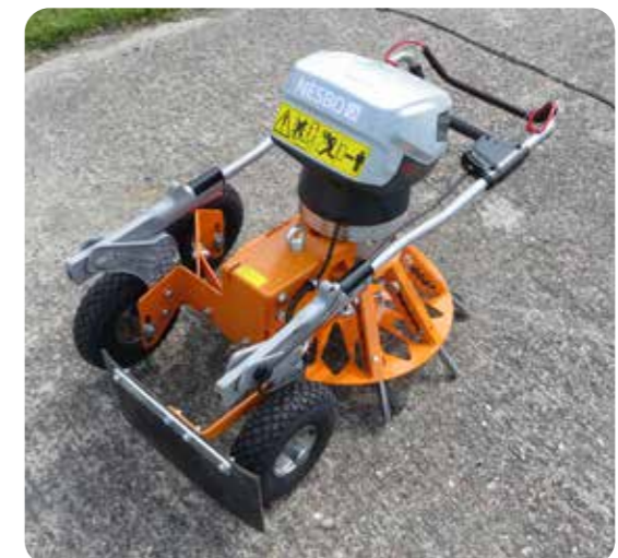
Højdeindstilleligt styr med sikkerhedsgreb
