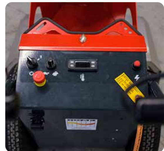
Temperaturmåler, elektrisk tænding og hastighedsregulering
