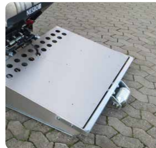
Frontrullen sikrer korrekt højdeafstand
