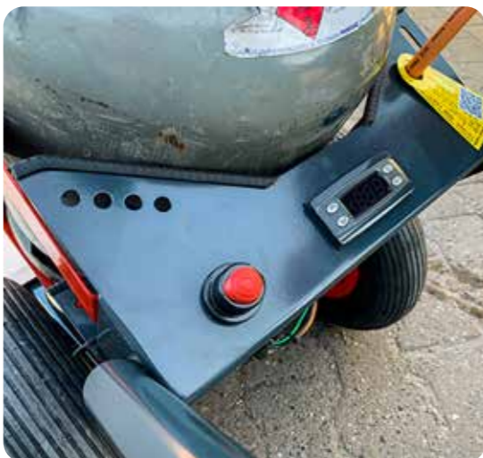
Elektronisk tænding, samt visning af temperatur
