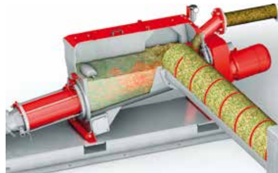
Snit af en CC-Mix, til højre på billedet: indføding af faste stoffer via en snegl
