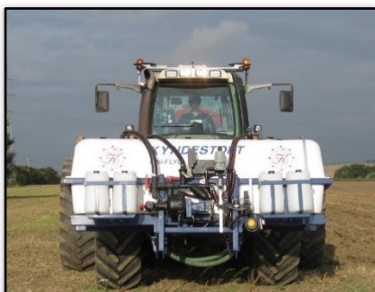
2000liter fronttank monteret med injektion for mikronæring
