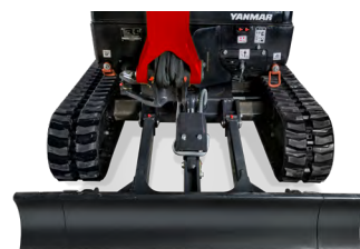
Understel kørt ud : 1 380 mm
