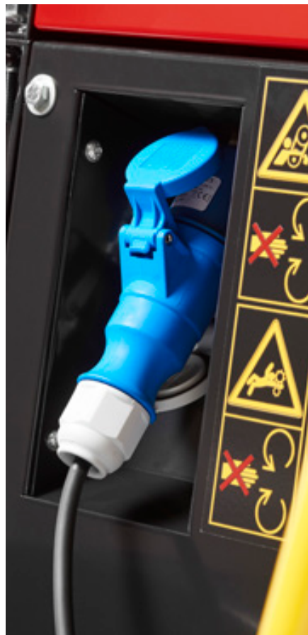
Integreret lader: 230V 16A 65V og kabel
