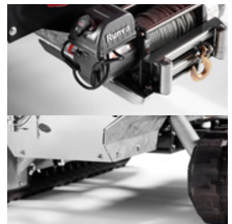
TP Spil kan anvendes, når flishuggeren skal op eller ned af skråninger. Største frihøjde på markedet: 200 mm. Variabel bæltevidde: 1150-1300 mm. Forstærket beskyttelse af hydraulikslanger.
