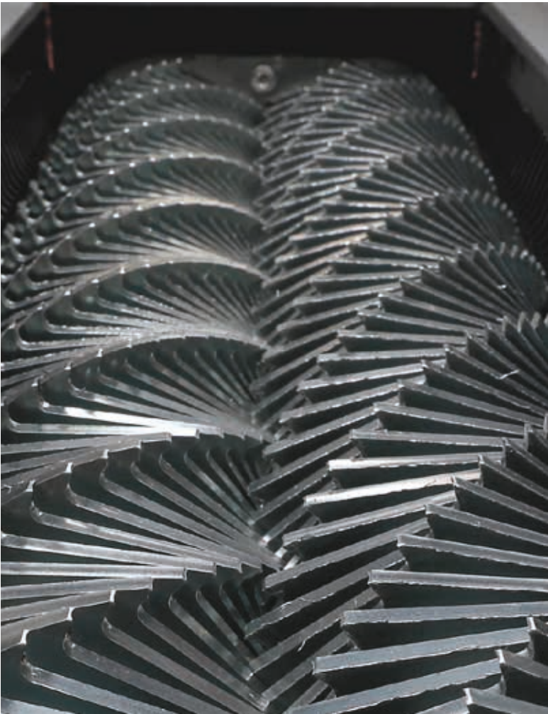
De monolitiske Ripper-rotorer i ét stykke er ekstremt stive og særligt nemme at vedligeholde.
