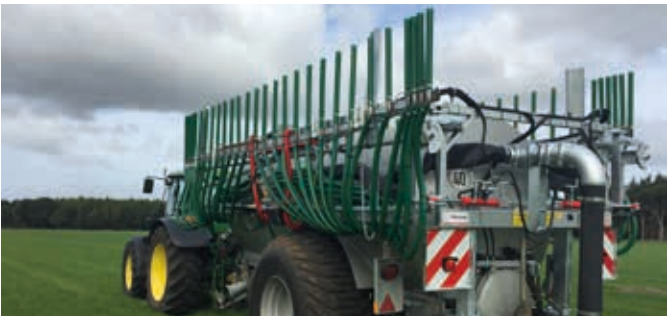
SwingUp slæbeslangebom 7,5 - 9 m Kompakte mål til fleksibel anvendelse
