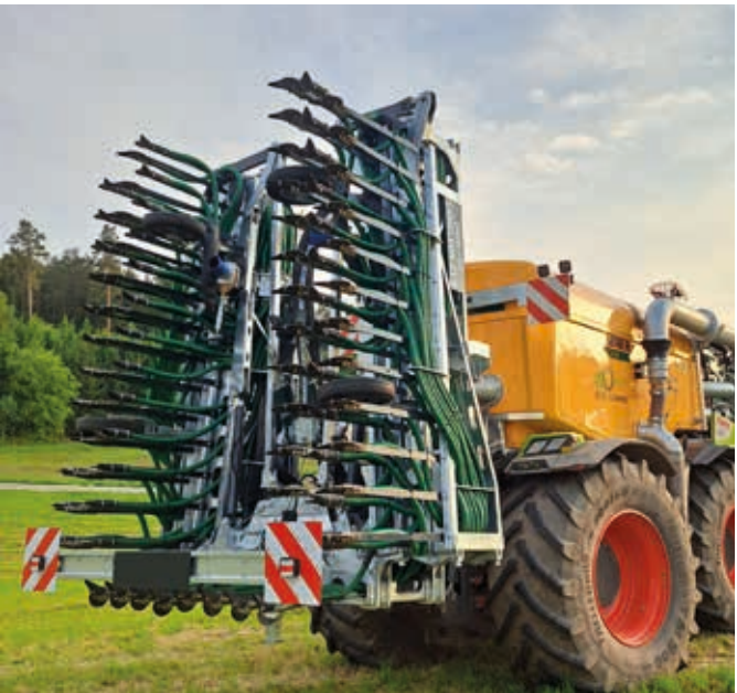
Cameleon Light slæbeskobom 12 - 15 m Stor arbejdsbredde og lav vægt til selvkørende køretøjer
